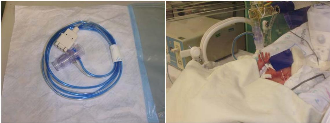
Figura 3 - Transdutor de fluxo Varfley BICORE<sup>®</sup>, modelo neonatal
