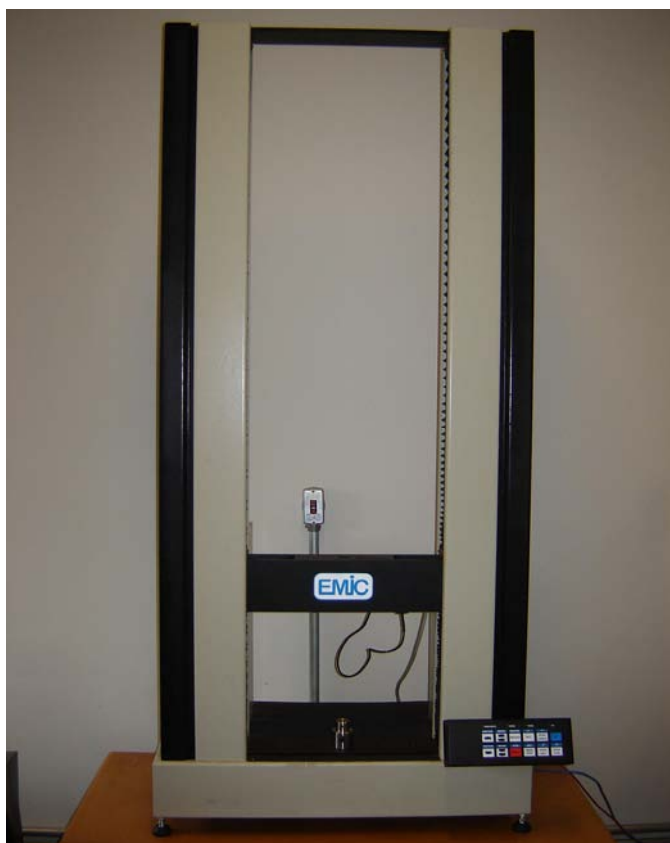
Fig. 10 – Máquina de ensaio universal EMIC
