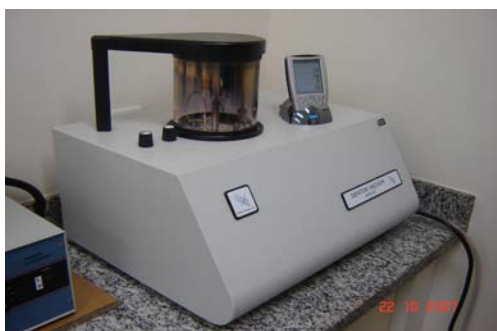
Fig. 14 – Metalização com ouro dos corpos de prova
