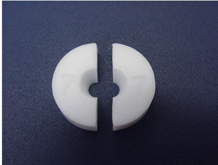
Fig. 8 - matriz de politetrafluoroetileno
