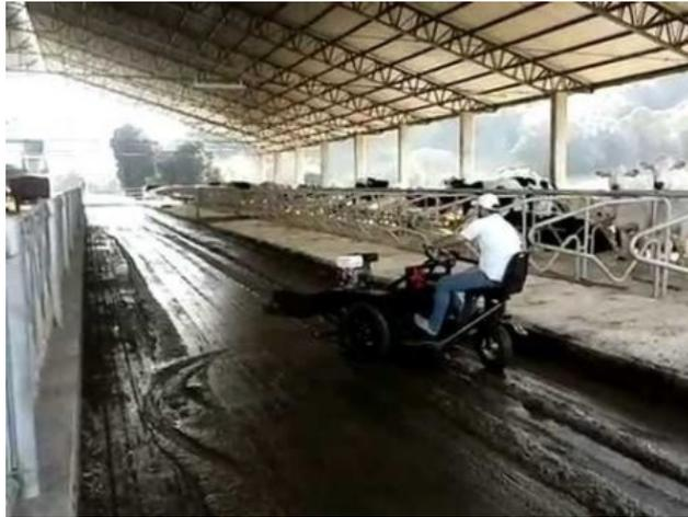
Figura 4: Exemplo de Equipamentos utilização para limpeza de dejetos bovinos
