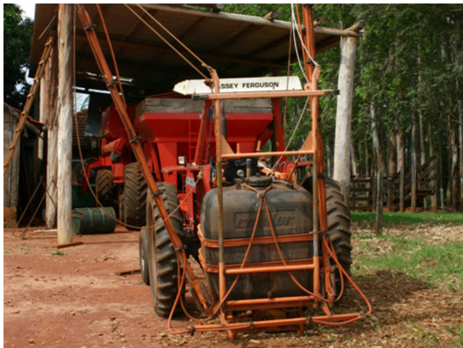
Figura 13 – Aplicador de agrotóxico acoplado à traseira do trator, de utilização no distrito de Culturama, município de Fátima do Sul, MS.
