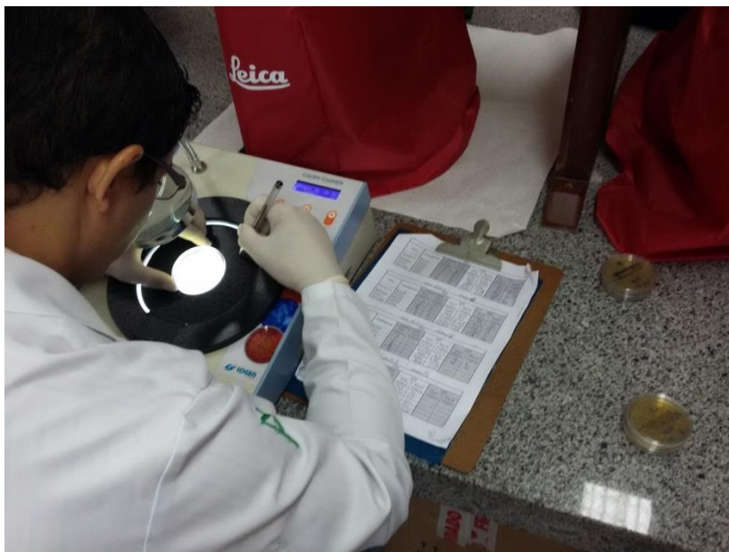
Figura 7: Contagem de colônias aeróbicas (CCA) pelo contador de colônias eletrônico/digital
