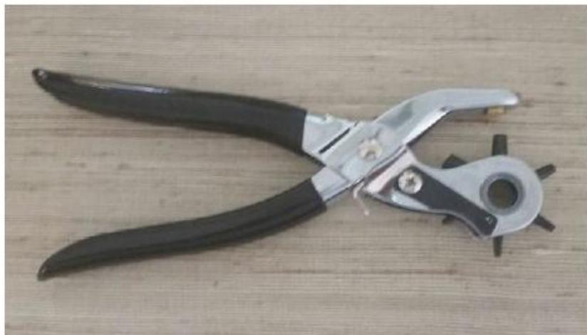
Figura 4.5 – Perfurador utilizado para confecção dos orifícios nas placas de silicone.
