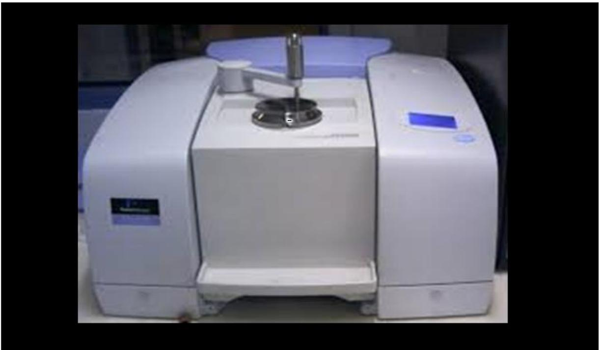
Figura 10 - Foto do corpo de prova sendo inserido e em posição para iniciar a leitura no FTIR
