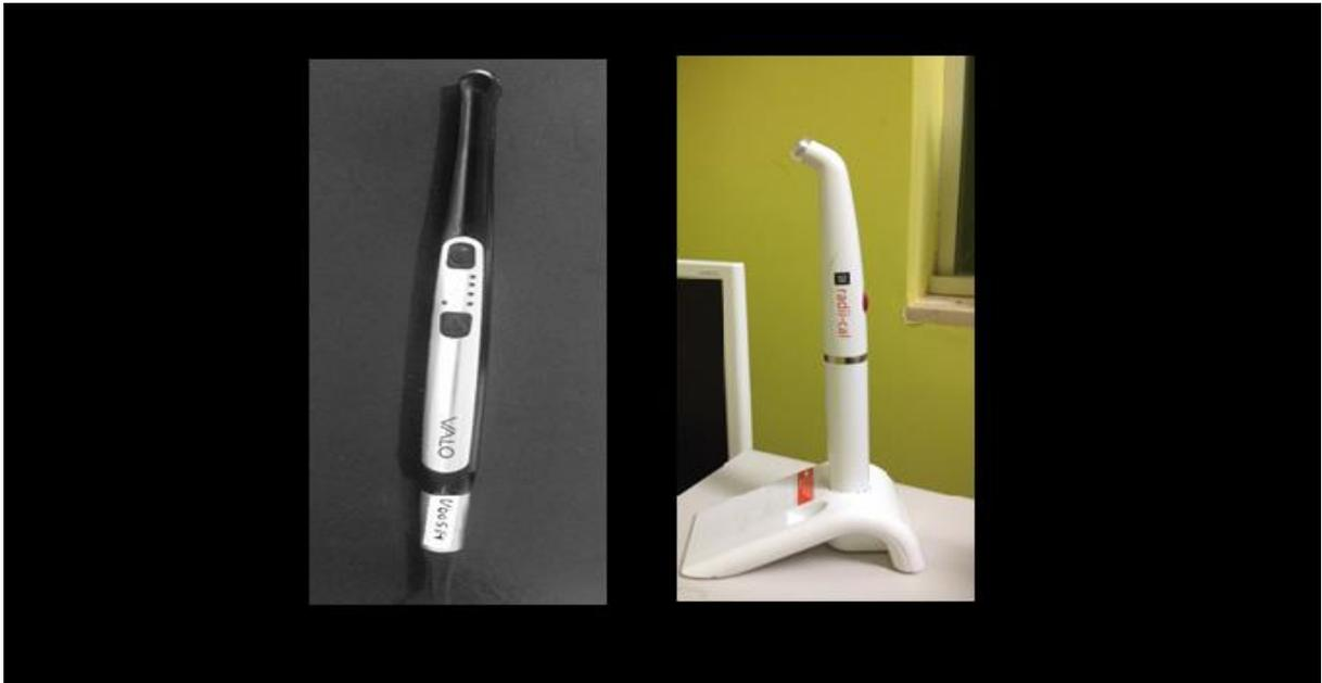
As ponteiros dos fotopolimerizadores foram posicionadas diretamente na superfície nos centros do CP em 2 mm e, para as distâncias de 4 e 6 mm, sobre o orifício central da matrizes metálicas sobrepostas, com a fotoativação realizada sobre eles em tempos distintos de 10 e 20 segundos. Para se obterem as distâncias em mm foram posicionadas as mesmas matrizes metálicas de alumínio uma sobre a outra.
