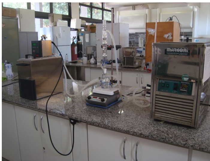
Figura 4 - Sistema da funcionalização das Nano ZnO montado com os banhos termostaticados de aquecimento a 50°C e refrigeração no condensador a 21°C.
