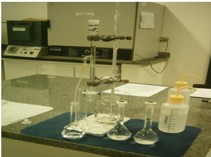
**FOTO 6 - PROCESSO DE REDUÇÃO NA COLUNA DE CÁDMIO**
