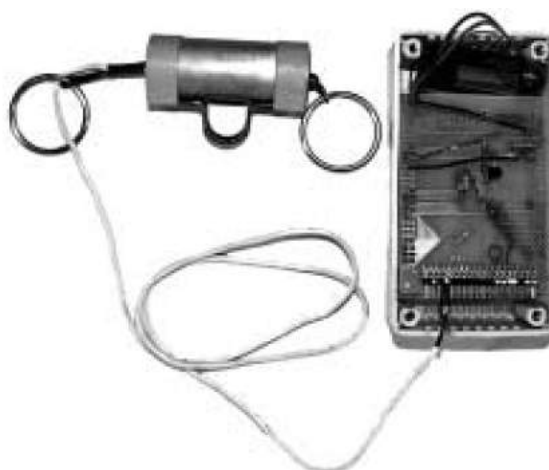
Figura 2.8: Circuito completo de monitoramento da FR [6].
