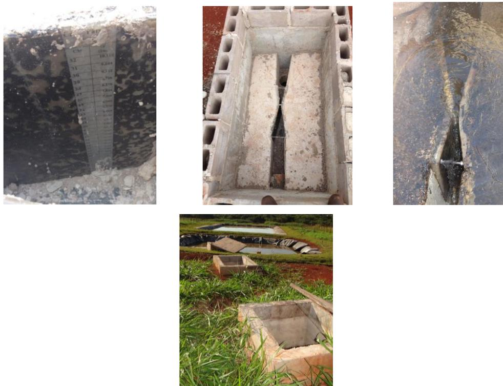
**Figura 7.12 – Medidores de vazão**
