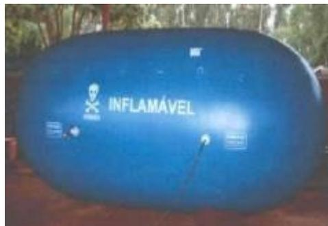
**Figura 7.16- Imagem do gasômetro projeto PUREFA**
