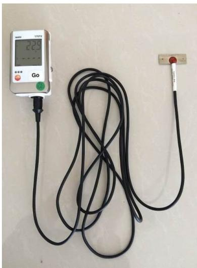
Figura 1: Imagem do Data Logger T175T2 e termopar tipo T.
