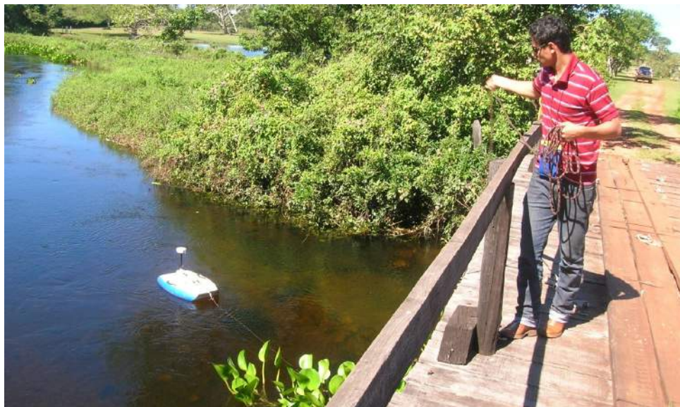
Foto 3 - Medida de vazão com ADCP no rio Salobra (município de Miranda).
