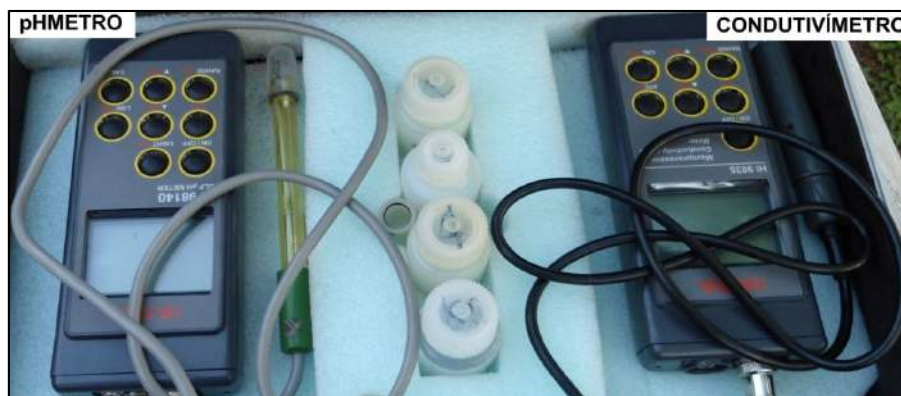
Foto 1 - pHmetro e Condutivímetro utilizados na aquisição dos parâmetros físico-químicos das águas.
