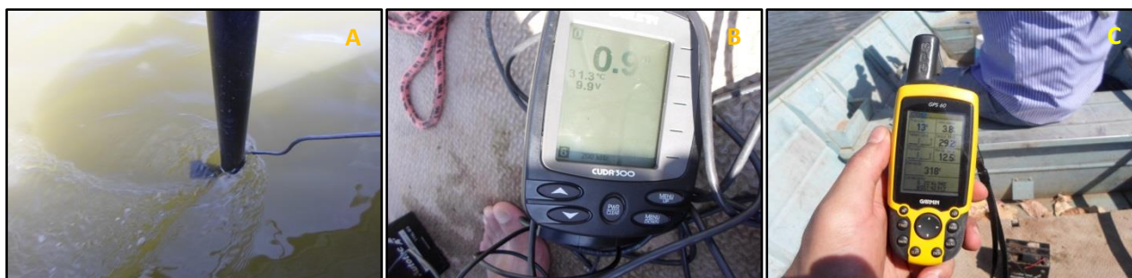
Figura 38: (A) Sensor submerso para captação de dados. (B) Resultado fornecido no visor do sonar. (C) Longitude e latitude sendo captada pelo gps.
