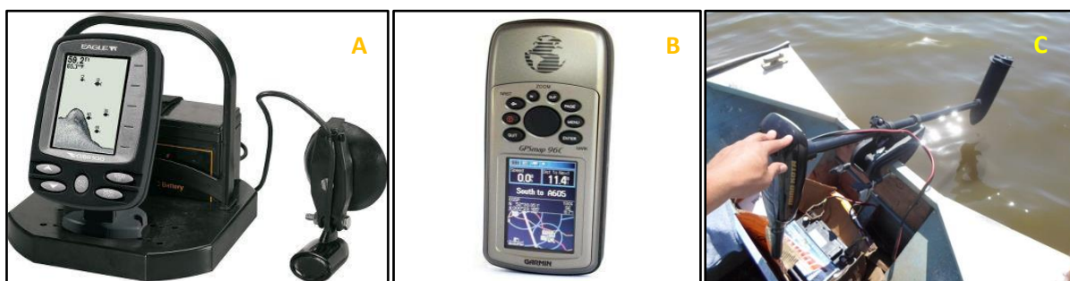
Figura 37: (A) Sonar CUDA 300. (B) GPS Garmin 76CSX. (C) Motor elétrico MINN KOTA Turbo alimentado pela bateria automotiva Júpiter.
