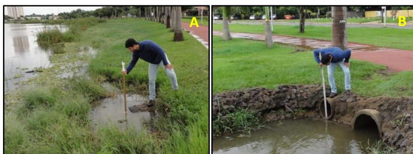
Figura 32: (A) Técnica de medição em campo utilizando o molinete. (B) Medição de um tubo para escoamento das águas para dentro da Lagoa Maior.
