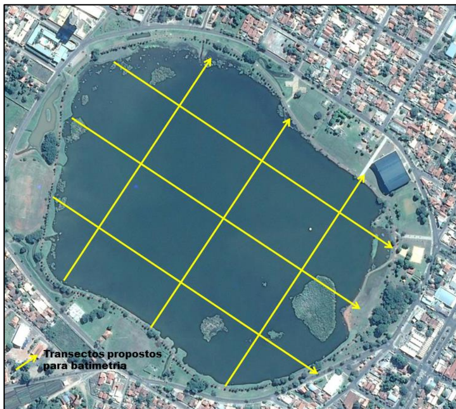
Figura 36: Metodologia de campo para obtenção da batimetria. Fonte: adaptado do Google Earth Pro (2014)
