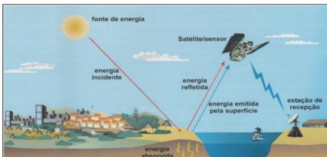
Figura 5: Obtenção de Imagem da Superfície Terrestre por meio de Sensoriamento Remoto
