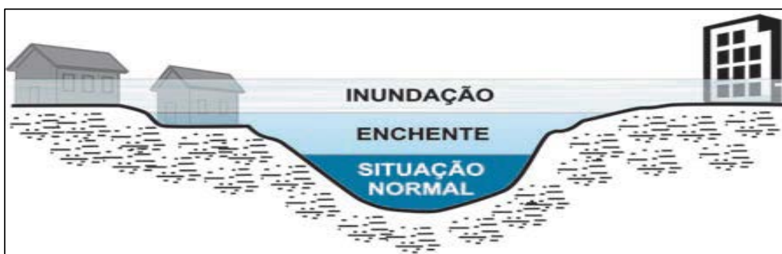
Figura 3: Perfil Esquemático do Processo de Enchente e Inundação
