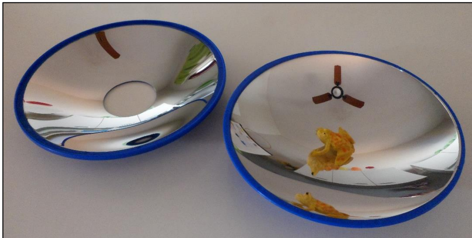
Figura 4.19 - Foto tirada pelo autor - kit educacional utilizado para o experimento “projeção de imagem real”.
