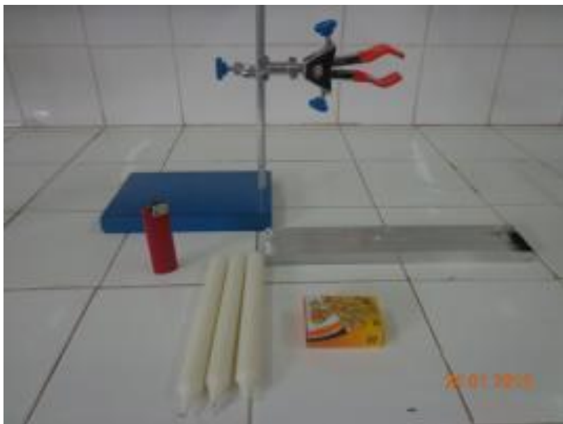
Figura 10: Atividade demonstrativa de condução térmica
