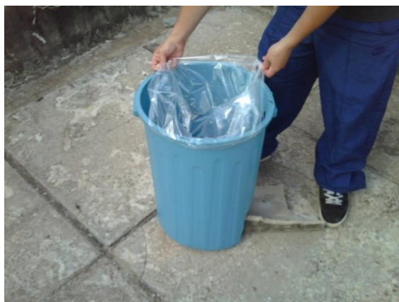
Figura 4.7 – Recipiente com o saco plástico para coleta direta da chuva.
