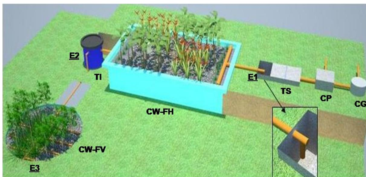
Figura 3.1 - Sistema híbrido de *wetlands* construídos. Detalhe com ampliação da canalização interna do tanque de sedimentação (TS). CG: caixa de gordura; CP: caixa de passagem; TI: tanque de alimentação intermitente. Pontos de coleta: E1, E2 e E3.
