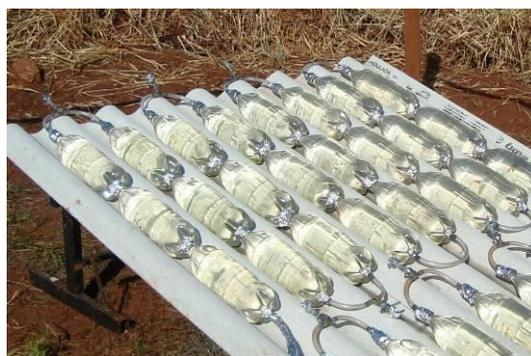
Figura. 4.1. Protótipo do sistema SODIS em fluxo contínuo.
