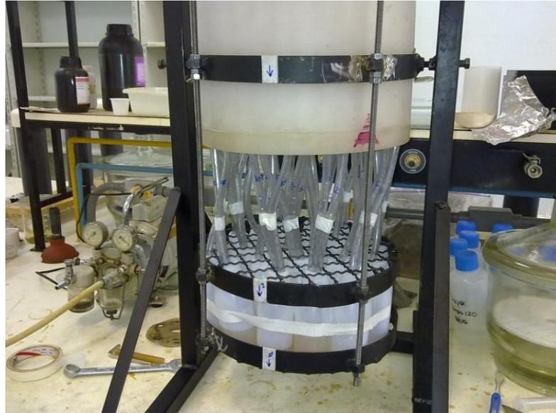
Figura 5.12 - Suporte giratório dos frascos montado sobre o cavalete.
