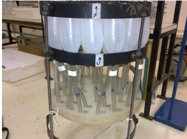
Figura 5.10 - Tampa extratora posicionada no suporte giratório dos frascos.
