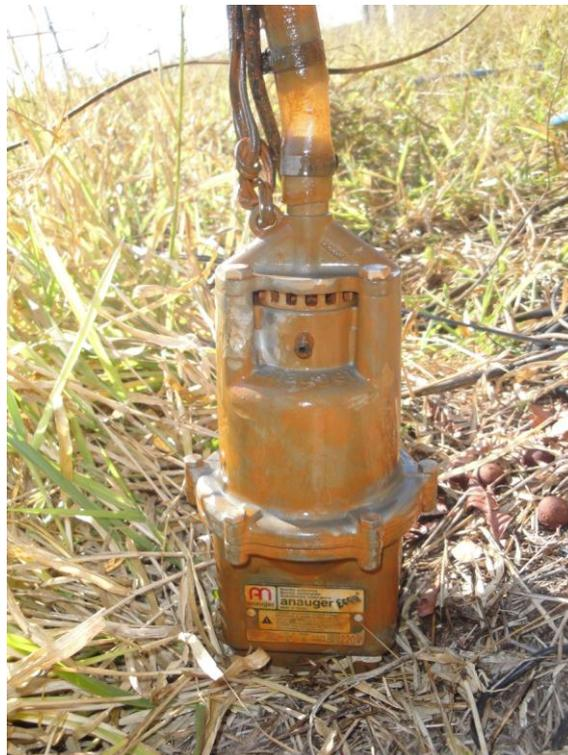
FIGURA 5.2: Bomba submersa com mineral de coloração avermelhada precipitada em sua superfície devido a inatividade do poço.
