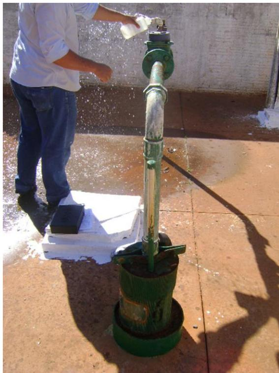
FIGURA 5.3: Detalhe da coleta da amostra logo após a boca do poço.
