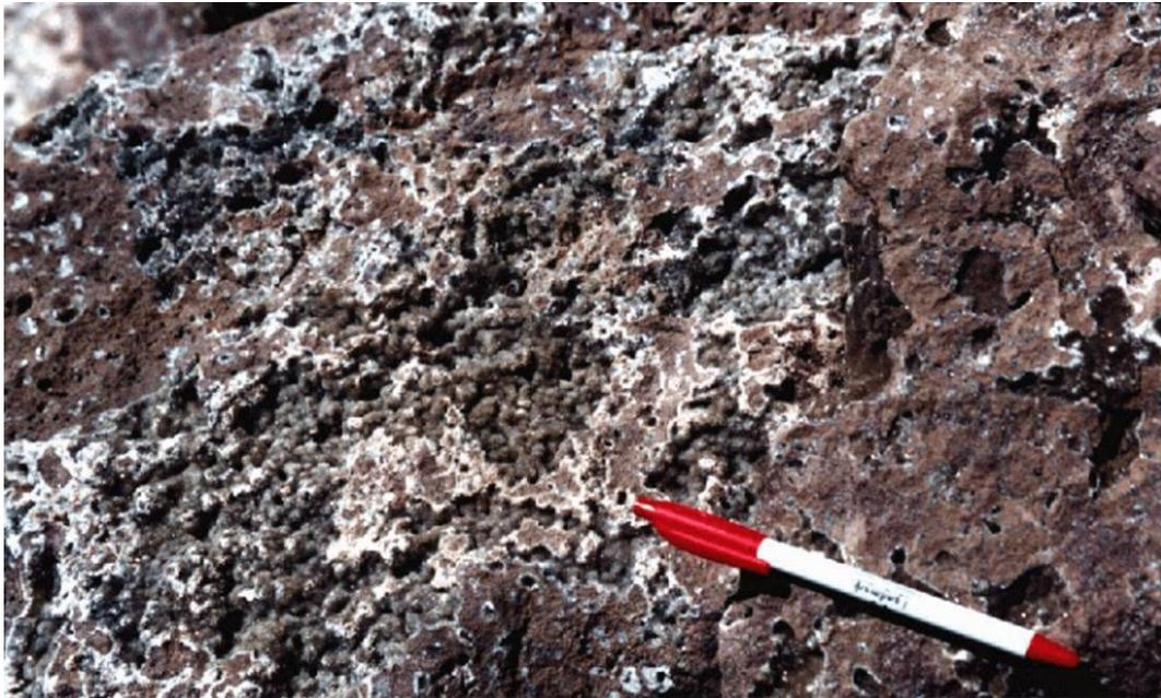
FIGURA 4.2: Exemplo de basalto vesículo-amigdaloidal em pedreira de Campo Grande/MS (Lastoria, 2002).
