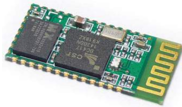
Figura 2.15: Módulo Bluetooth HC-05 utilizado para a comunicação serial sem fio.
