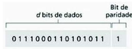
Figura 2.8: Verificação usando um único bit de paridade. Retirado de [41].
