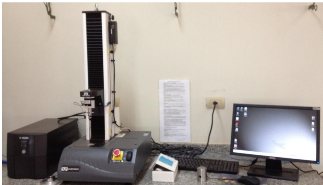
Figura 26 - Máquina Universal de Ensaio Instron® (Grove City, EUA), modelo 3342.
