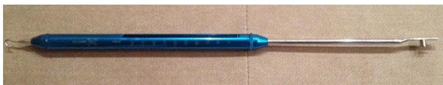
Figura 16 – Dinâmometro soldado ao uma estrela de Boone.
