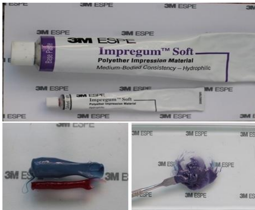
Figura 5 - Material de moldagem para simulação do ligamento periodontal.
