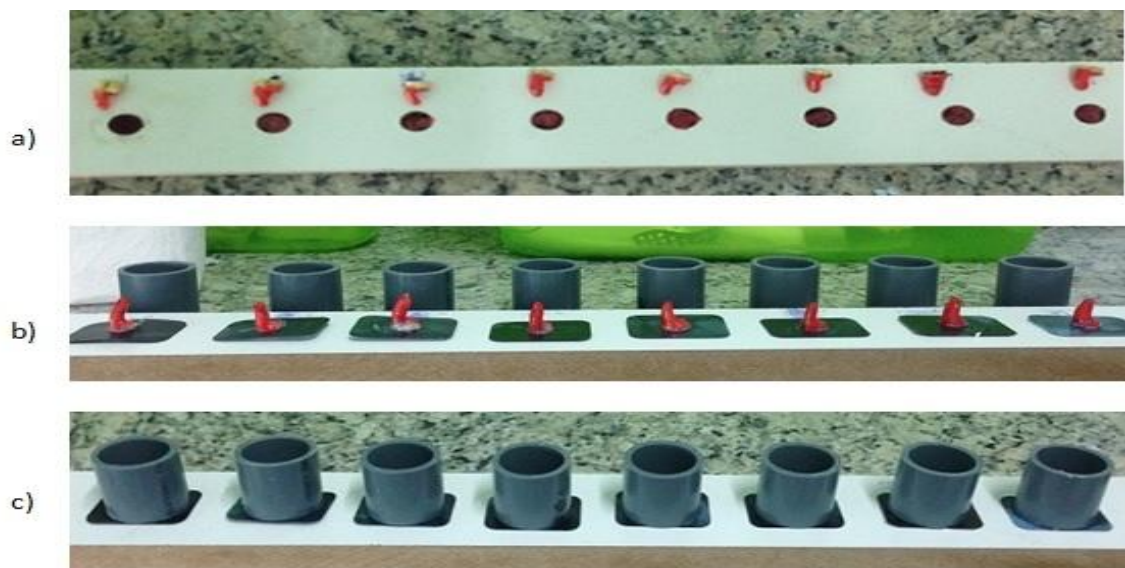
Figura 3 - a) raízes após imersão e secagem da cera; b) raízes invertidas e fixadas por películas radiográficas; c) tubos de PVC colados sobre as películas.
