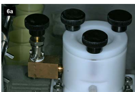
Fig. 6 – Funcionamento da Máquina de permeabilidade. 6a: Verificação do preenchimento da câmara de filtração através da observação de um pequeno escoamento de água; 6b: Medida do deslocamento da bolha de ar no tubo capilar; 6c: Valor observado no visor do paquímetro.
