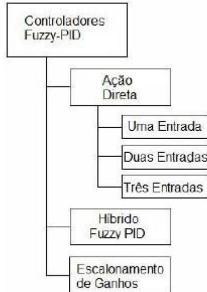
*Figura 2.9: Classificação dos controladores Fuzzy-PID. Fonte: Adaptado de (ERENOGLU et al, 2006).*
