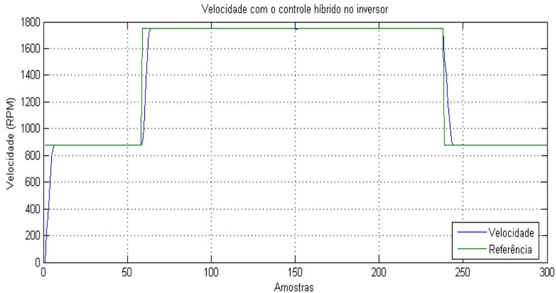
**Figura 4.12:** Velocidades do controle híbrido no inversor.
