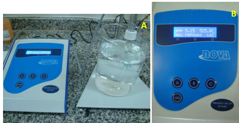
Figura 9 – a. Aferição do pH da solução desmineralizante utilizada no experimento; b. Vista aproximada do mostrador digital do phmetro.
