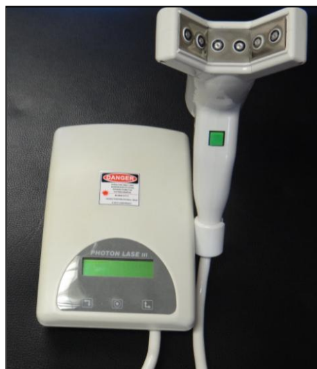
Figura 5 - Laser arsenieto de gálio e alumínio (GaAlAs) (Protótipo) DMC® modelo Photon Laser III.
