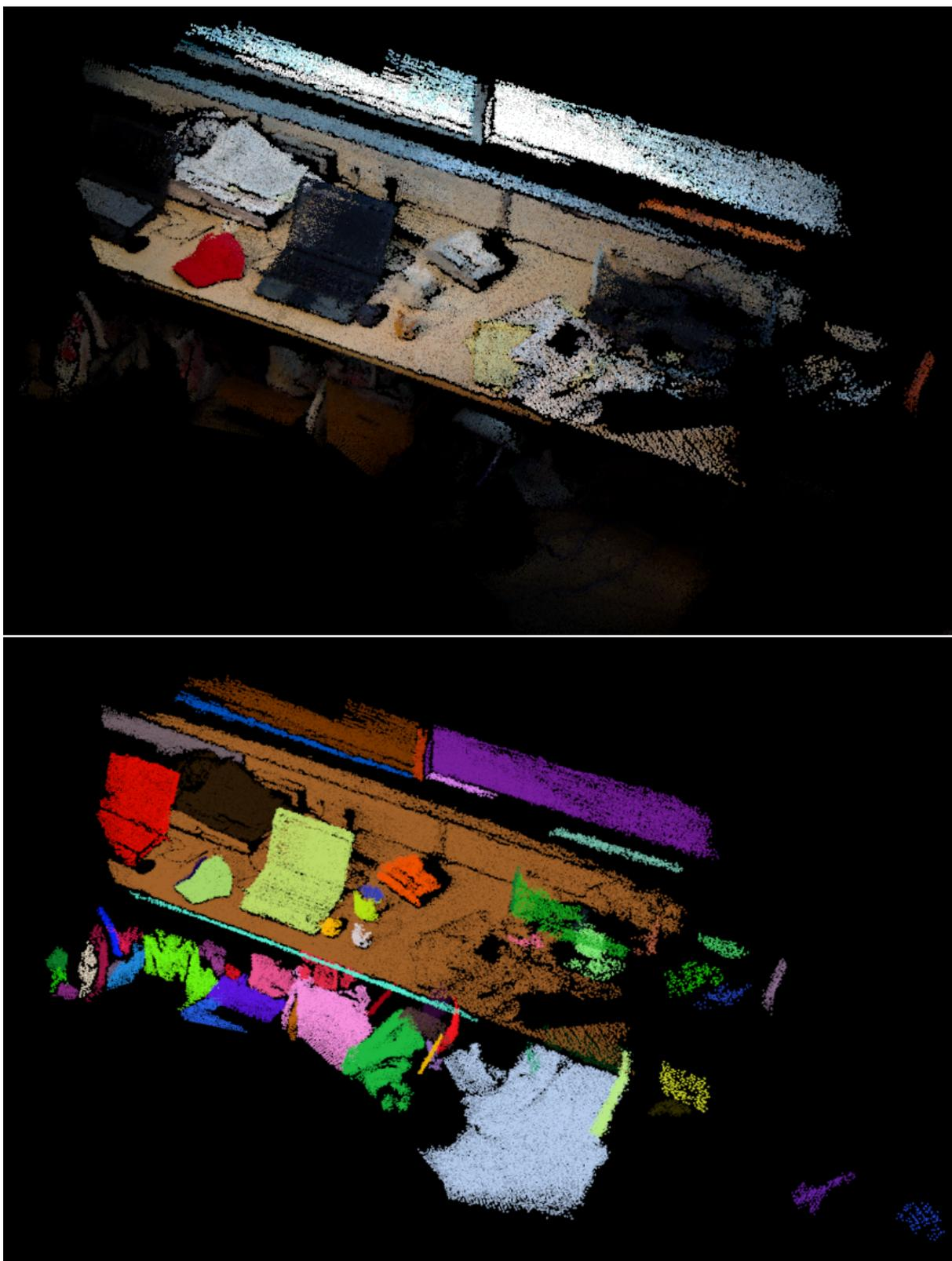
Figura 4.8: Resultado da nuvem de pontos após a segmentação. Acima é exibida a nuvem de pontos original, onde não existe o conceito de segmentos. Abaixo a nuvem de pontos resultante do algoritmo. Cada cor representa um segmento
