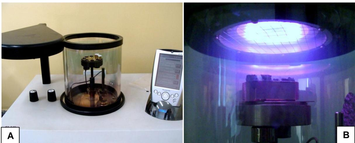
**Figura 9 – A e B:** Metalização dos espécimes para análise ao microscópio eletrônico de varredura.
