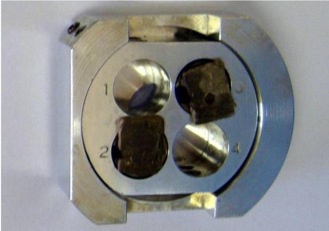
**Figura 10-** Peças metalizadas e montadas para observação em microscopia eletrônica de varredura.
