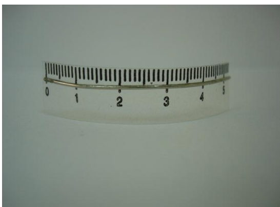
Figura 6 – Medida do fio de metalico com régua flexível
