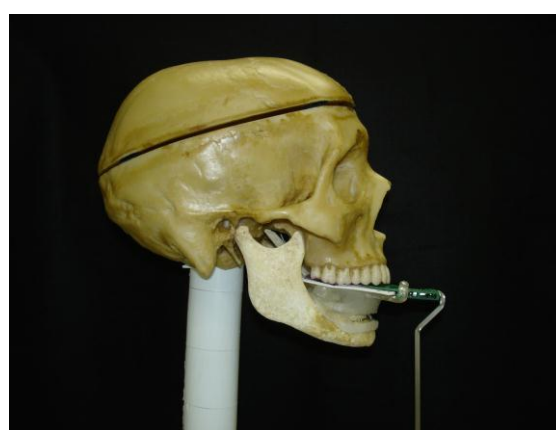
Figura 9 – Suporte e receptor de imagem preso na mandíbula.
