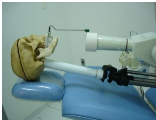
Figura 13–Distância do foco do raios X
