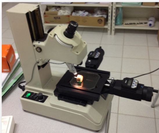
Figura 8 – Corpo de prova posicionado no microscópio com os dispositivos de medida acoplados, para mensuração da fenda na interface I-P.
