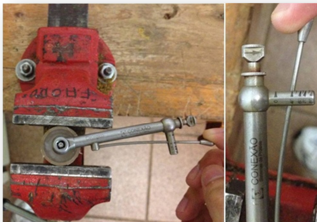
Figura 6 – Torque de 40\text{N/cm}^2 sendo aplicado a um dos implantes.
