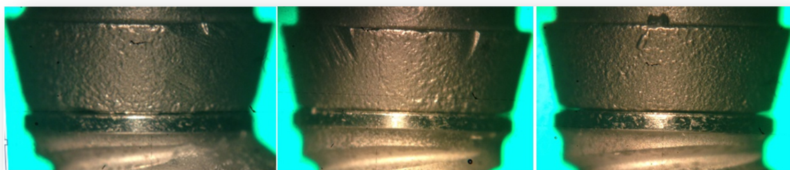
Figura 14 – Visão do microscópio óptico evidenciando a adaptação do pilar UCLA à plataforma dos implantes de torque interno nos grupos G2, G4 e G6(da esquerda para direita).
