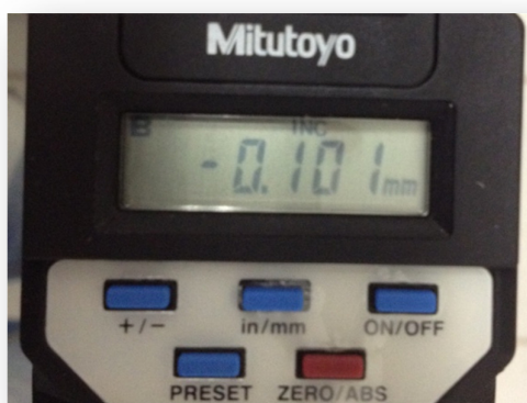
Figura 10 – Visor do dispositivo de medida mostrando o valor obtido na media com precisão de micrometros.
