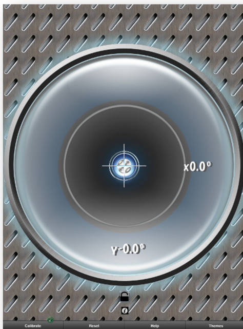
Figura 4 – Tela do aplicativo All levels demonstrando a ausência de inclinações nos eixos “x” e “y”, garantindo o paralelismo da placa de vidro com o plano horizontal.
