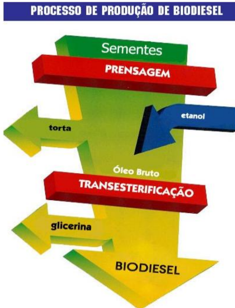
Figura 4 - esquema da produção do biodiesel pelo processo de transesterificação.
