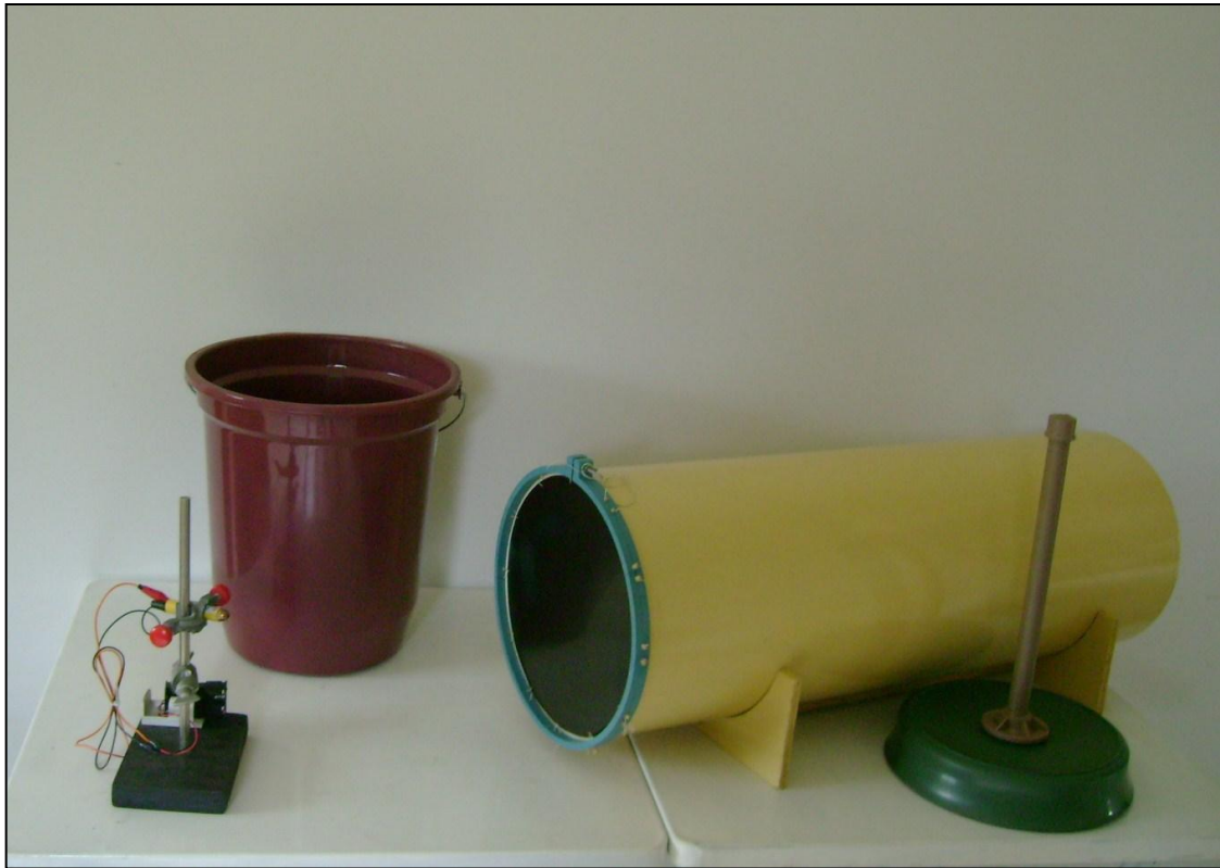
Figura 8 - Segunda versão do dispositivo experimental elaborado para estudar ondas-DEEDO.
