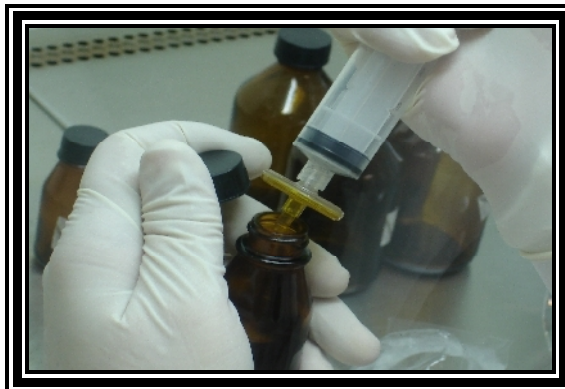
Figura 6 - Filtragem em membranas planas de 0,22 \mu\text{m} (Millipore®).
