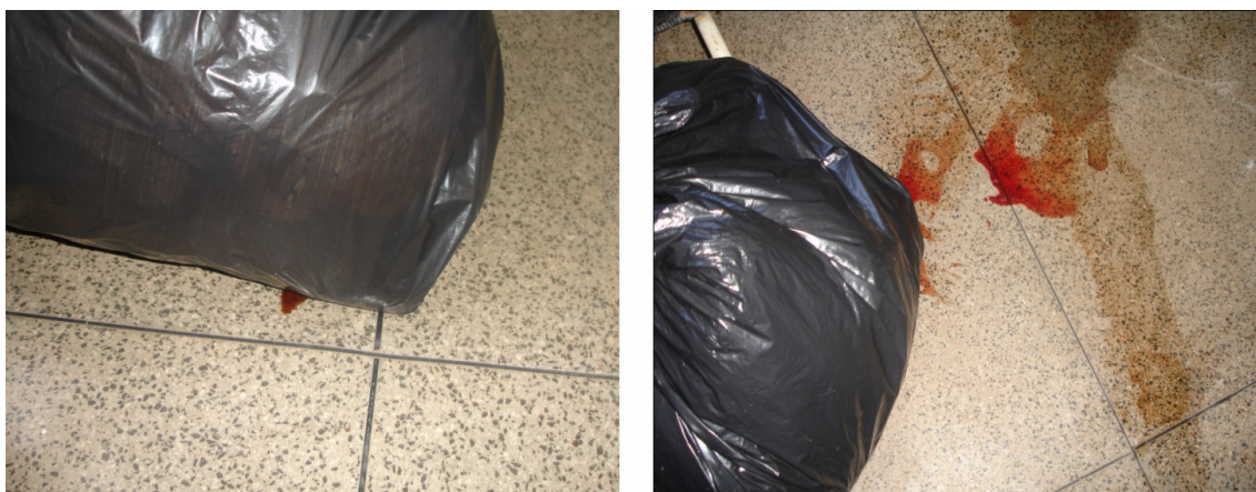
Figura 5.5- Fotos de sacos utilizados para o acondicionamento de RSS não resistentes à ruptura e vazamentos.
