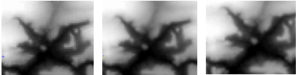
(a) SRTM 90m (USGS, 2008). (b) SRTM, 30m (VALERIANO, 2008) (c) SRTM 30m (HIGA, 2009) Figura 5.2 - Zoom nos dados SRTM de 90 e 30m, evidenciando as diferenças em consequência da reamostragem. Com os dados SRTM de 30m, (b) e (c), é possível um melhor delineamento das feições.
