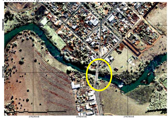
Fusão Ikonos-2, MSS e banda pan, pixel de 1m.
