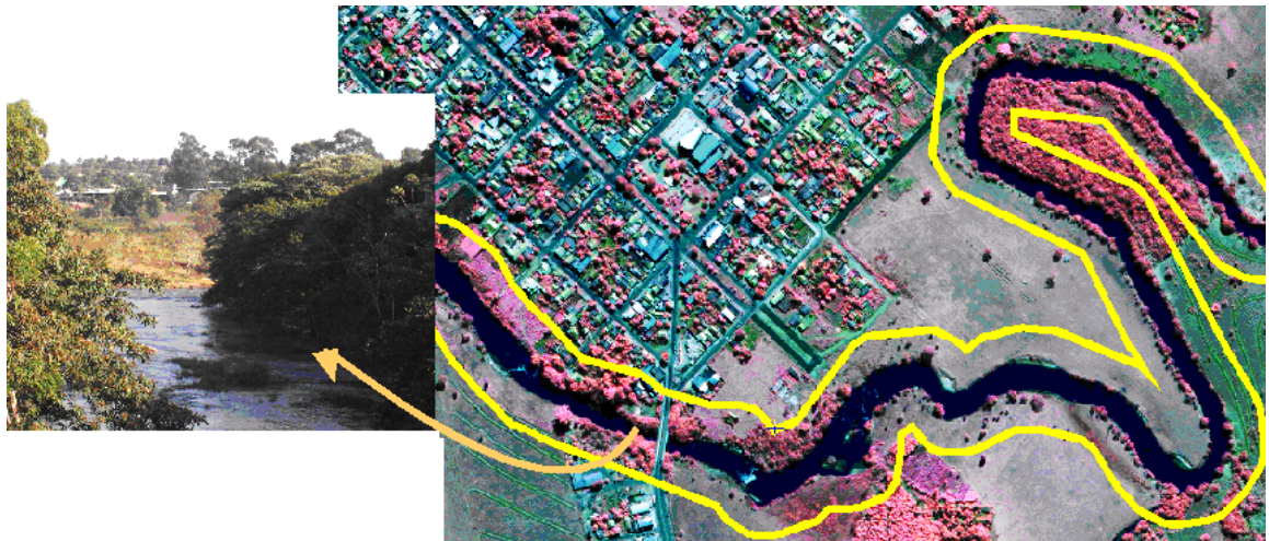
Figura 5.5 – Ponte central de Costa Rica – MS, com a delimitação das faixas de APP em amarelo, com 30m de largura em cada margem sobre uma imagem fusionada IKONOS (RGB 432) com resolução espacial de 1m, servindo ainda, como referência para a análise das figuras 3 e 4.
