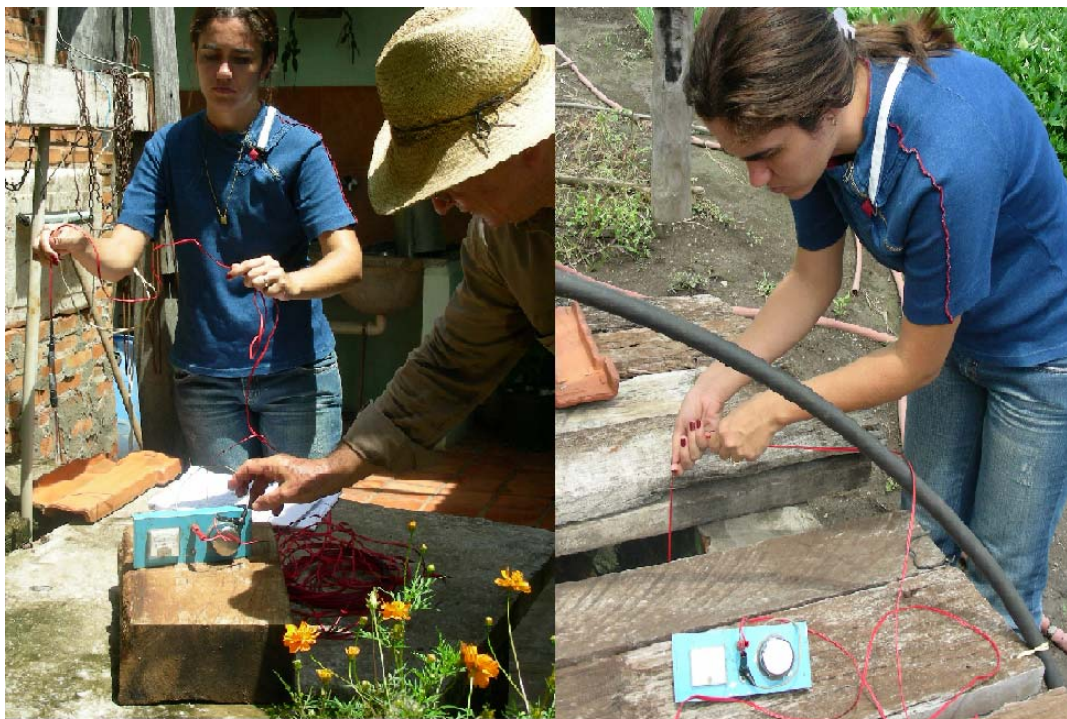
FIGURA 4.7 – Detalhe do medidor elétrico de nível d'água.
