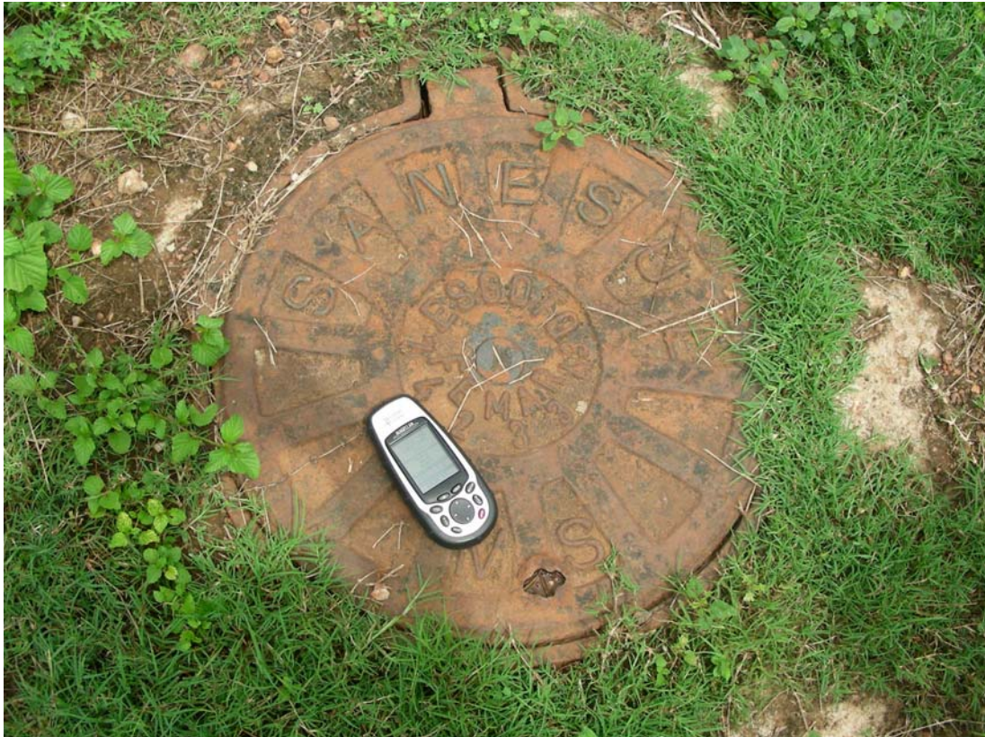
FIGURA 4.5 – Aferição da altitude indicada pelo GPS, com ponto cotado no terreno.
