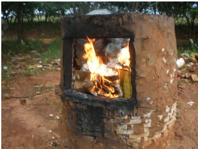
Figura 5.45 - Queima de resíduos infectantes no forno 1.
