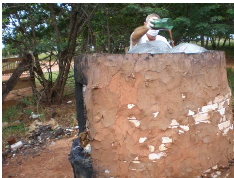
Figura 5.44 – Combustível sendo adicionado ao forno de queima 2.
