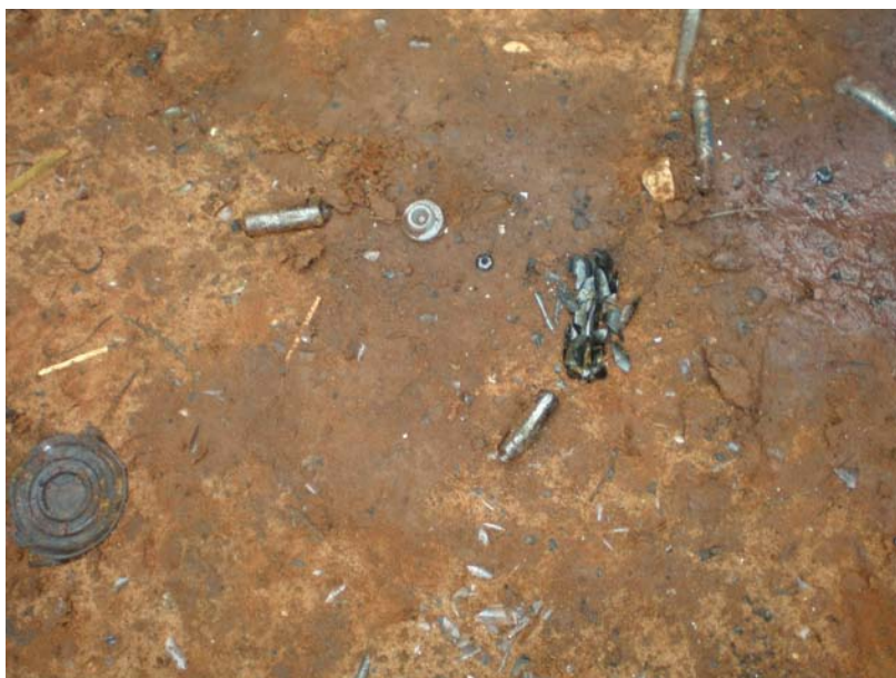
Figura 5.48 – Foto retirada do chão, próximo ao local de queima, contendo escórias geradas no processo.
