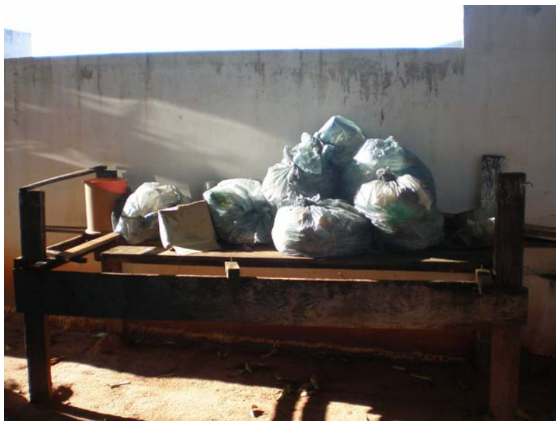
Figura 5.32 - Armazenamento externo de resíduos infectantes. Observa-se os sacos de acondicionamento com cor inadequada.
