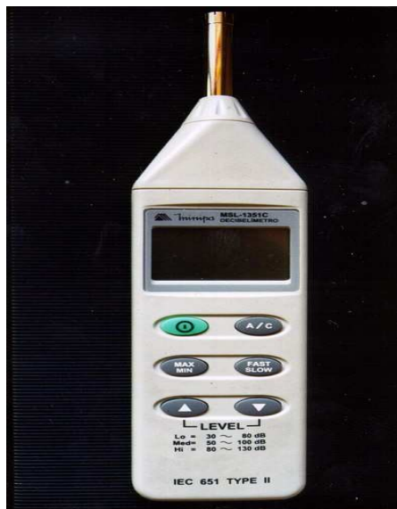
Figura 4.4 - Decibelímetro MINIPA, modelo MSL 1351C
