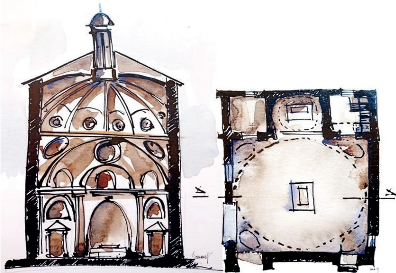
Figura 3.3: Croquis - corte e planta da Sacristia velha de San Lorenzo, Florença (1421), de Brunelleschi. Fonte: Elaborado por Gomes R. F. (2025).
