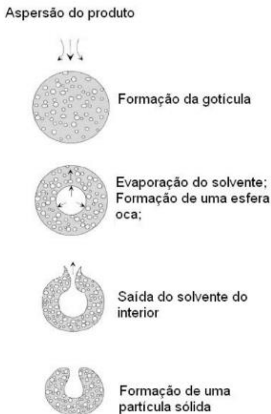
Figura 6 - Formação da partícula sólida por spray drying.
