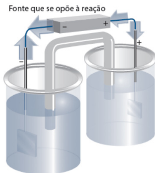
Figura 2: Esquematização básica da Célula Eletrolítica
