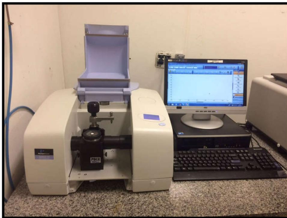
**Figura 5:** Equipamento PerkinElmer Spectrum 100 FTIR spectrometer acoplado a microcomputador servidor.
