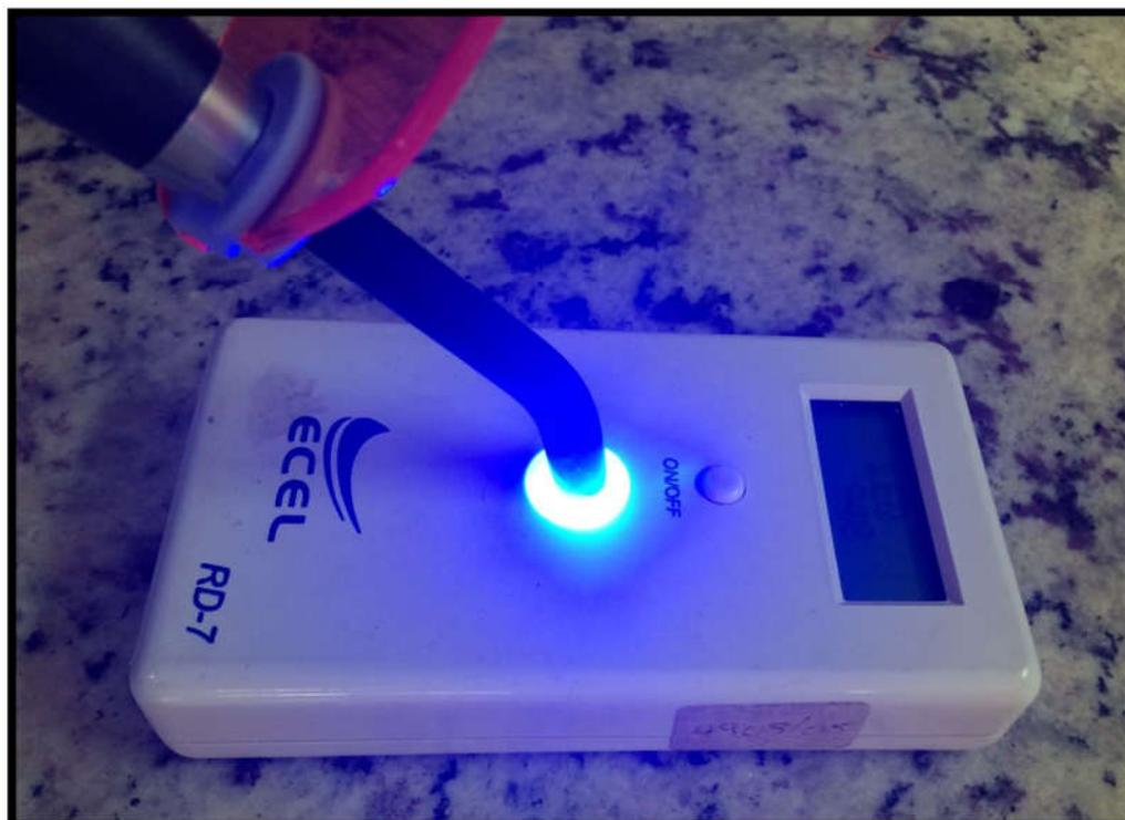
**Figura 2:** Aparelho LED Emitter D sendo mensurada sua potência por meio de um radiômetro digital comercial RD-7.
