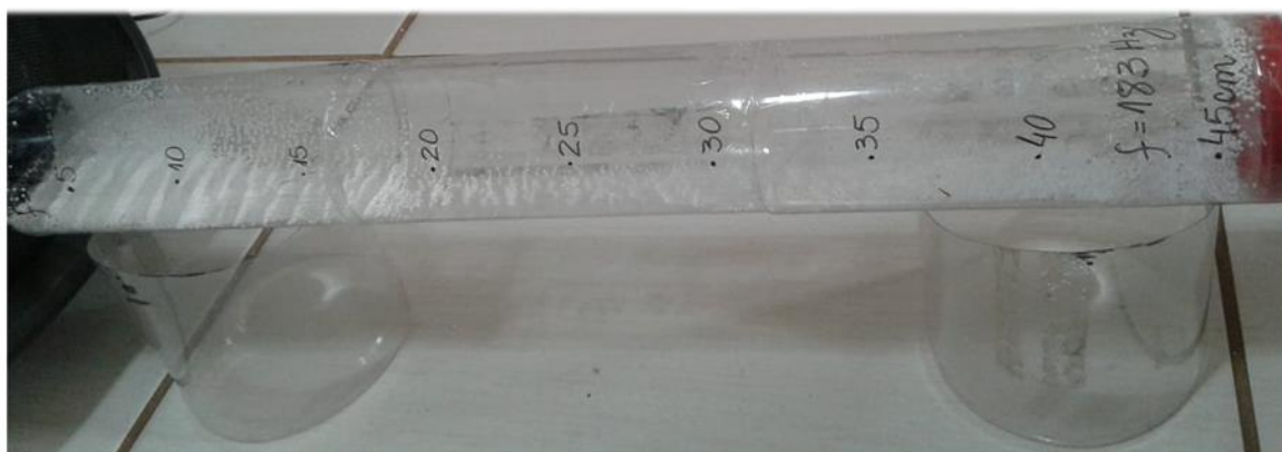
FIGURA 27 - TUBO DE KUNDT FEITO DE GARRAFA “PET” E BOLINHAS DE ISOPOR VIBRANDO COM ONDA SONORA DE 183HZ
