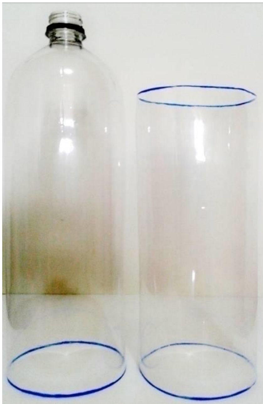
Figura 5. Garrafas pet cortadas para confecção de tubos sonoros.
