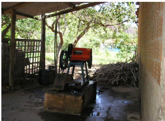
Figura 15 – Engenho de cana elétrico
