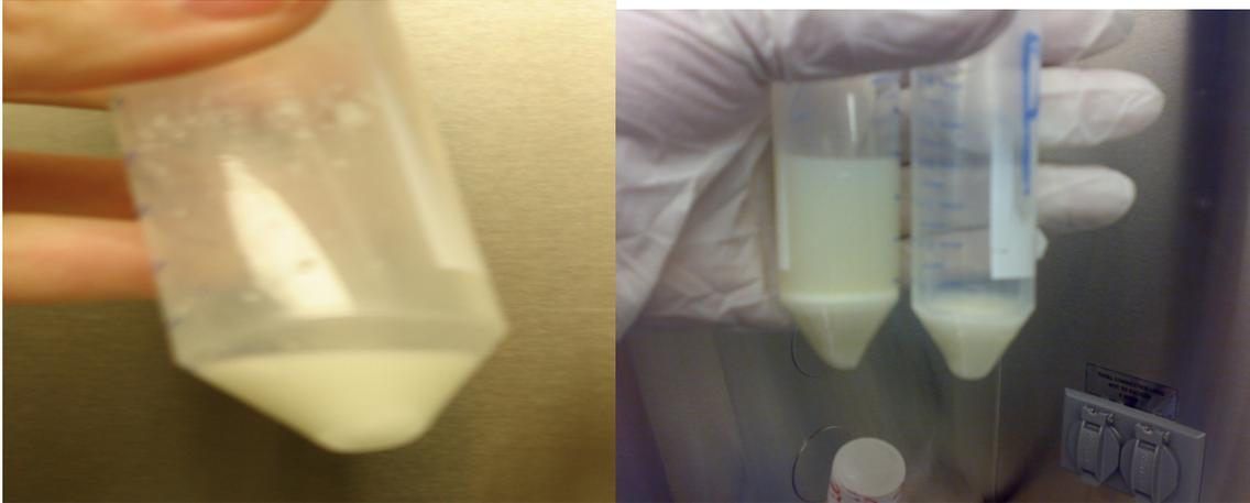
FIGURA 4 – Precipitado de lactose depois da retirada do sobrenadante.
